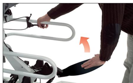
Comando a leva per la verticalizzazione servo-assistita da molla a gas. L'altra leva regola in altezza la struttura con una seconda molla a gas.
